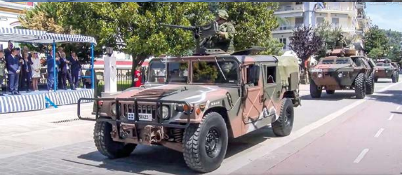
Εδώ και κάτω δεξιά: M1097A2 με πολυβόλο 0.50 και πολυβόλο MG3 στον πτυσσόμενο έστορα του συνοδηγού
