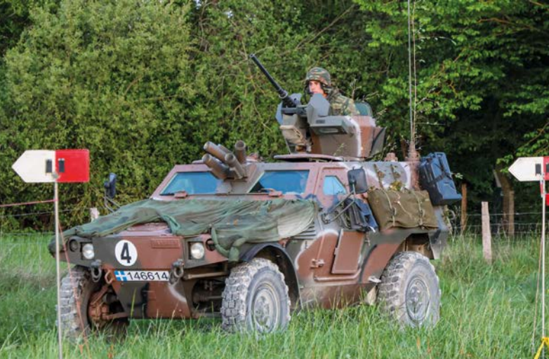
VB2L, η έκδοση με μακρύ μεταξόνιο του Panhard VBL (Véhicule Blindé Léger) που φαίνεται εδώ με πυργίσκο PL127. Έχουν αναβαθμιστεί πρόσφατα με εκτοξευτές καπνογόνων τοποθετημένων ανάμεσα στα 2 εμπρός παράθυρα.
