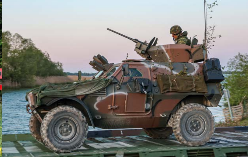
VB2L, η έκδοση με μακρύ μεταξόνιο του Panhard VBL (Véhicule Blindé Léger) που φαίνεται εδώ με πυργίσκο PL127. Έχουν αναβαθμιστεί πρόσφατα με εκτοξευτές καπνογόνων τοποθετημένων ανάμεσα στα 2 εμπρός παράθυρα.
