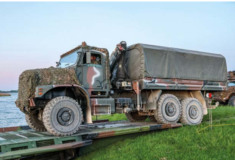
Ένα MTVR Mk27 ετοιμάζεται να διασχίσει τη γέφυρα. Αυτή η έκδοση, που παραγγέλθηκε το 2006, είναι ειδική για τη μεταφορά πυρομαχικών τεθωρακισμένων μονάδων. Σχεδιασμένο από την Oshkosh αλλά συναρμολογημένο στην Ελλάδα από την ΕΛΒΟ, περίπου σαράντα οχήματα βρίσκονται αυτή τη στιγμή σε υπηρεσία.
