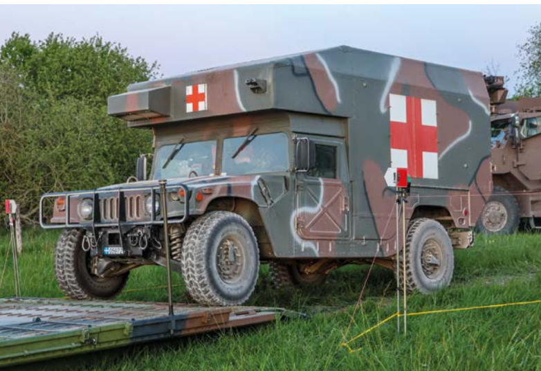
Αριστερά: Ένα ασθενοφόρο M1116 GR περιμένει να κινηθεί προς τη γέφυρα. Υπηρετούν 70 μονάδες από το 2006. Το M1116 GR είναι η ελληνική έκδοση του M997, που συναρμολογήθηκε από την ΕΛΒΟ. Δεξιά: Ένα Mercedes G290 GD με ρυμουλκούμενο υδροφόρο 1 τόνου.
